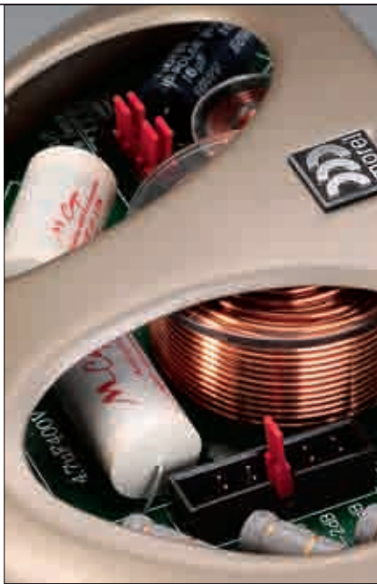
▲ Используйте переключатели для выбора степени аттенуации твитера и для обеспечения нужной крутизны среза кроссовера
